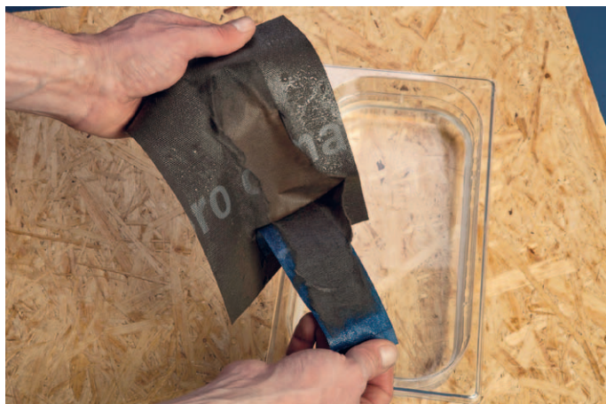
▲ Test přilnavosti pásky pro klima TESCON VANA pod vodou
