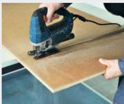
Formátování desky Wolf pomocí přímočaré pily.
